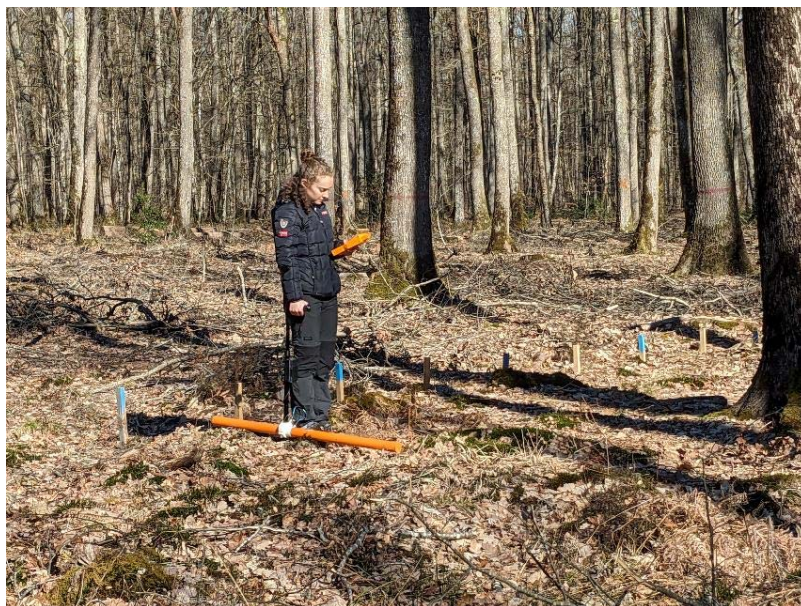
Mesures électromagnétiques : eau -> 1m80
